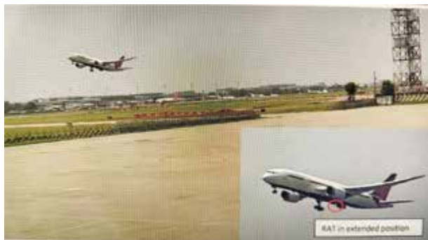
起飛時RAT外突，顯示引擎失去動力。
